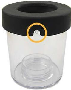
6. 将杯子填充至带有快速校准标准的刻度线处。将设备放置在校准杯内并选择下一个。
