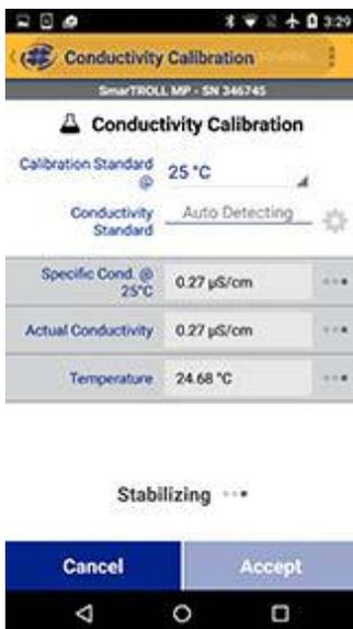
7. 检查校准标准瓶以确定参考温度。如有必要，点击下拉列表并选择适当的校准参考温度。
