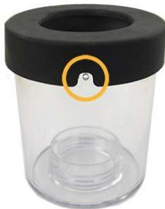
7. 将杯子填充至带有快速校准标准的刻度线处。将设备放置在校准杯内并选择下一个。
