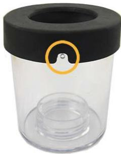
5. 将杯子填充至带有快速校准标准的刻度线处。将设备放置在校准杯内并选择下一个。
