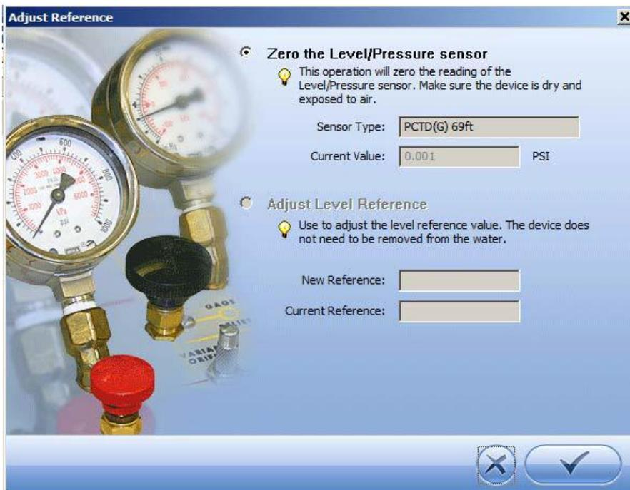
6. 选择归零水平传感器/压力传感器（Zero the Level/Pressure sensor）选项。
